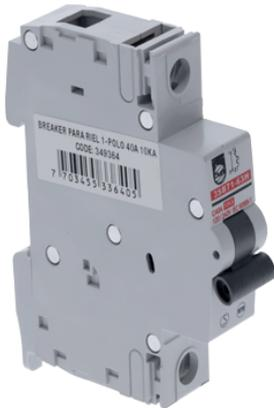
Los interruptores de riel se montan y fijan en un riel omega dispuesto dentro del tablero eléctrico. Este riel actúa como una guía y soporte para los interruptores, permitiendo una instalación ordenada y estructurada. La conexión eléctrica se hace mediante una barra de peines, con capacidad de carga acorde con la capacidad de corriente nominal del tablero.
